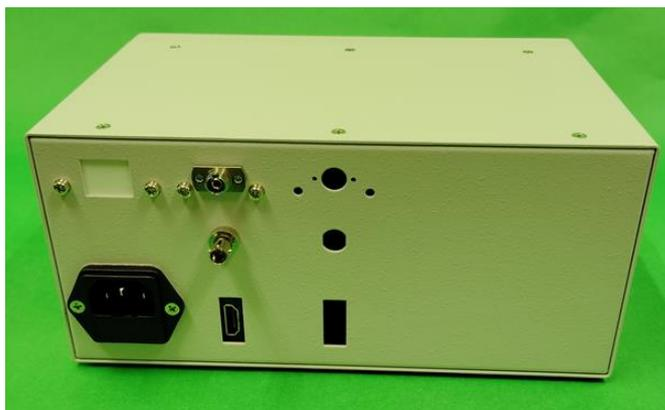
コントローラに光ケーブルを接続します。青 FC ケーブルは Control へ、黄 ST ケーブルは Camera ジャックへ差し込んで下さい。
